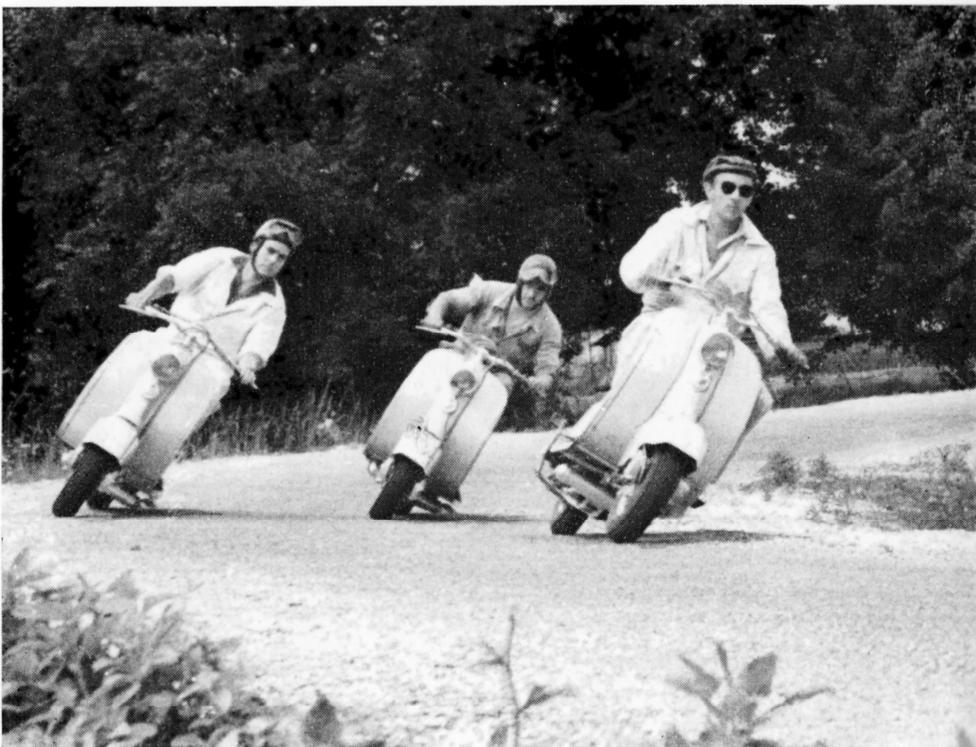
A sa « tombée de chaîne », les essayeurs s'emparent du scooter et s'élancent vers la piste. L'oreille et le doigté du spécialiste décèleront à coup sûr le réglage trop riche du carburateur ou l'insuffisance de la garde d'embrayage.
