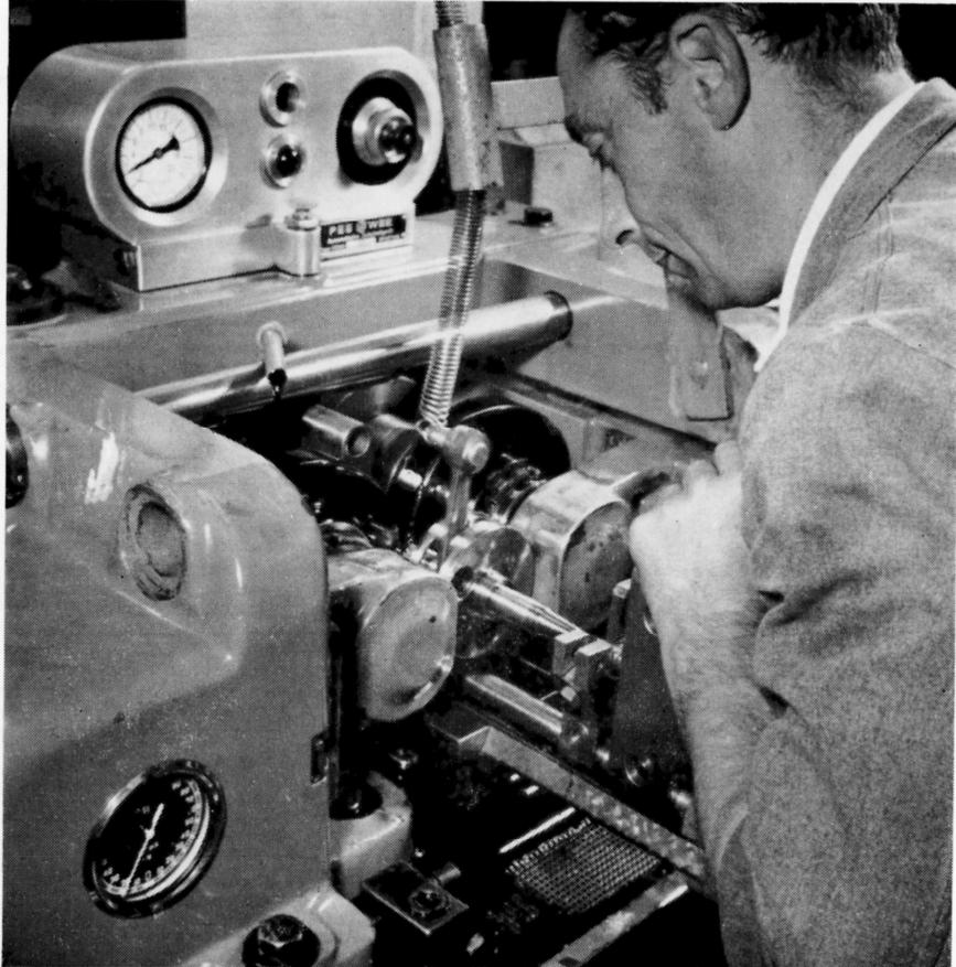
La cage à aiguilles et la bielle sont alors montées sur le maneton dont l'assemblage avec les deux flasques se fait à la presse.
